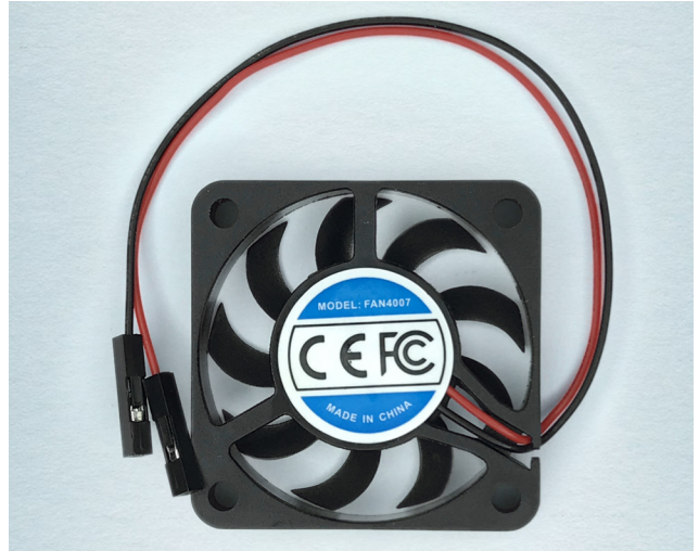
Figure 9. RPi cooling fan
