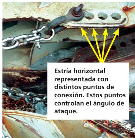
**Estría horizontal representada con distintos puntos de conexión. Estos puntos controlan el ángulo de ataque.**
