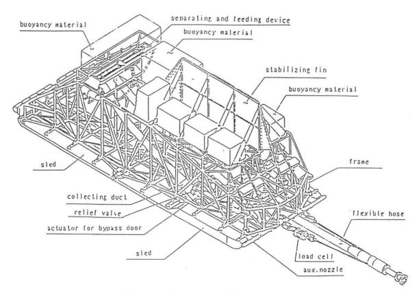
Fig. 2 BIRD'S EYE VIEW OF THE MINING COLLECTOR
