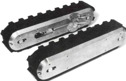
FIGURE 13 INUKTUN MINITRACK CRAWLER UNITS
