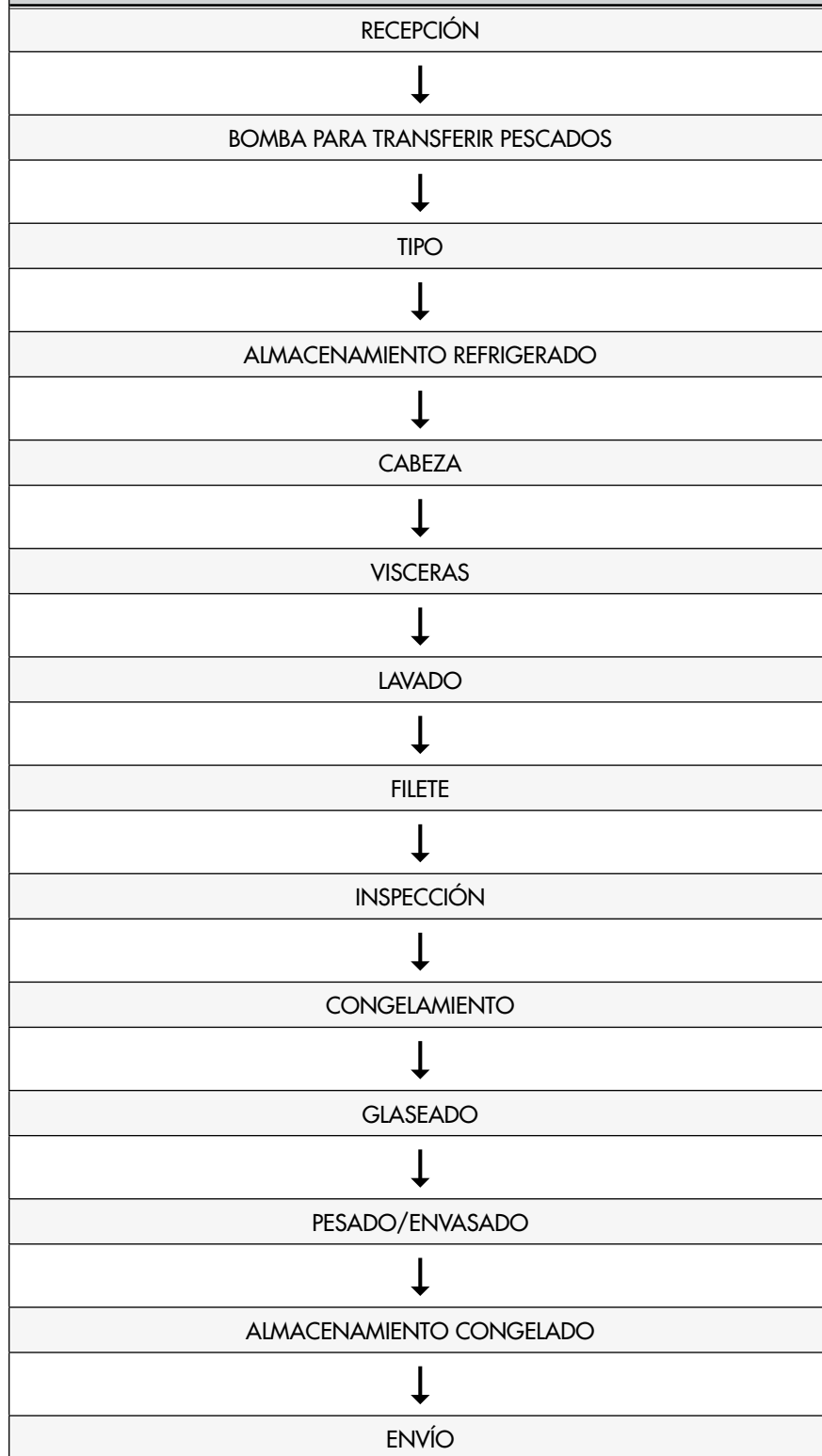
FIGURA A-1 DIAGRAMA DE FLUJO DEL PRODUCTO DE MUESTRA (FILETES DE SALMÓN)
