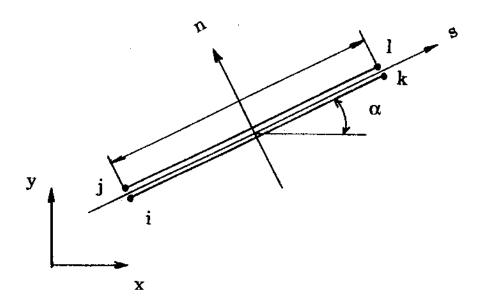
Fig. 2.1 Joint Element
