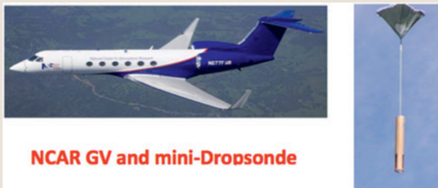
FIG. SBI. The NCAR NSF GV aircraft and new mini dropsonde.
