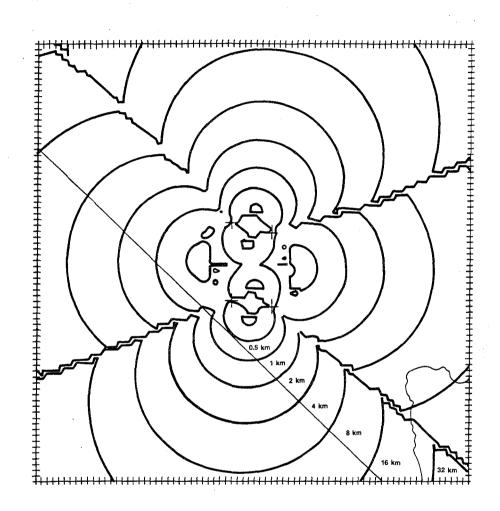
FIGURE 4 NTS/ALDS SYSTEM ACCURACY (CONTOUR PLOT SHOWING LINES OF EQUAL ACCURACY. VALUES ARE THE LENGTH OF THE SEMI-MAJOR AXIS OF A 50% PROBABILITY ELLIPSE.)
