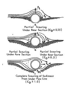
Fig. 2 TYPICAL EROSION PATTERN AT AN EXPOSED PIPELINE
